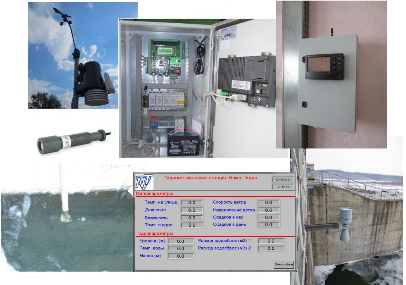
Рис. 2 Внешний вид элементов гидропоста “Нэкт-Гидро”
